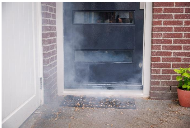
Effect blowerdoor test bij woning in de Rietkampen
