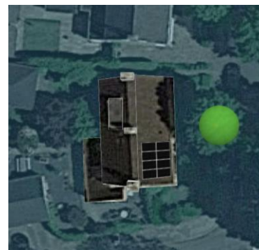
Voorbeeld legplan 9 PVT-panelen
